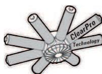
Permet d'atteindre grâce à de nouvelles crépines poreuses un niveau très fin de filtration d'une qualité 4 fois supérieure à celui d'un filtre à sable conventionnel (environ 10µ contre 40µ). Les crépines agissent comme des filtres supplémentaires créant une barrière additionnelle contre les plus fines particules donnant une pureté de l'eau proche des filtres à diatomée avec la fonctionnalité des filtres à sable.
